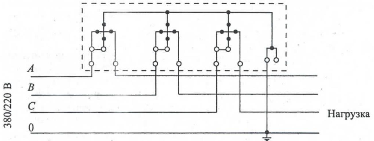
Схема подключения трансформаторного счетчика. Схема выполнена десятипроводной. Токовые цепи счетчика гальванически не связаны с цепями напряжения, а разделены. Подключение каждого из измерительных элементов счетчика требует обязательного соблюдения полярности токовых цепей и соответствия их своему напряжению.
