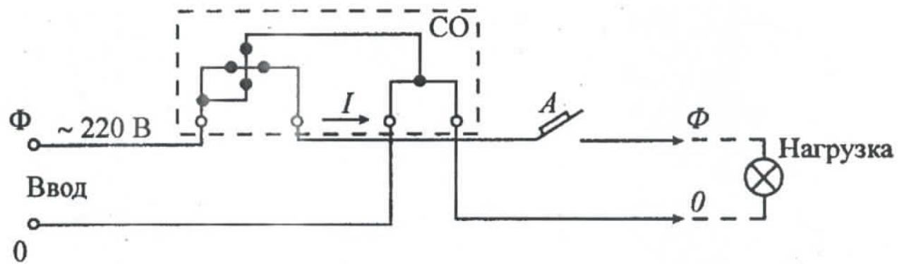
Схема прямого (непосредственного) подключения трехфазного счетчика электроэнергии. Счетчики прямого включения рассчитаны на номинальные токи 5, 10, 20, 50, 100 А. Подключение токовой цепи этих счетчиков осуществляется последовательно с сетевыми проводниками и обязательным соблюдением полярности.
