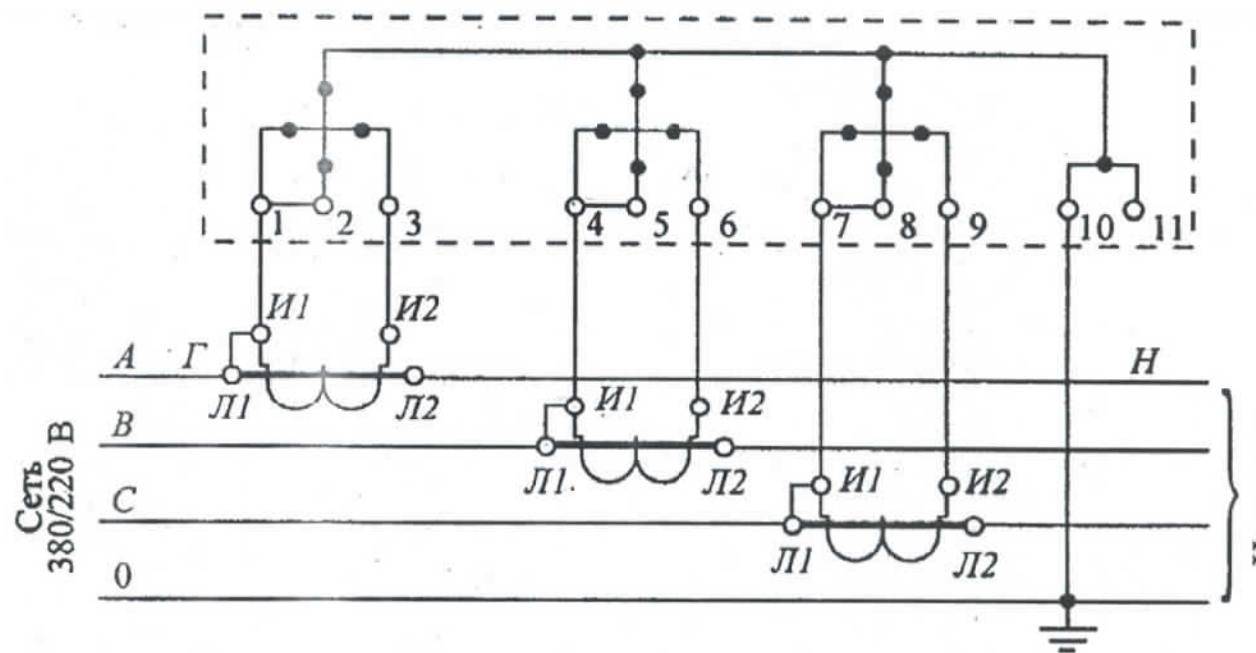
Схема подключения трехфазного счетчика через испытательную коробку. Испытательная коробка позволяет, не отключая проводов нагрузки, произвести замену счетчика и проверку схемы включения.
