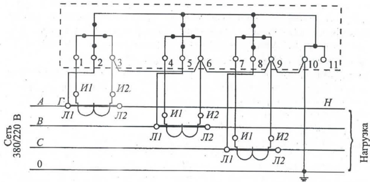
Схема трансформаторного подключения трехфазного счетчика (семипроводная). В этой схеме выполнено объединение цепей тока и напряжения. Совмещение цепей тока и напряжения выполняется установкой перемычек на счетчике и трансформаторе тока.
